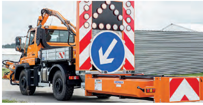
Die Dämpfungsglieder haben eine besondere Wabenstruktur, um die Aufprallenergie effektiv abzuleiten.
