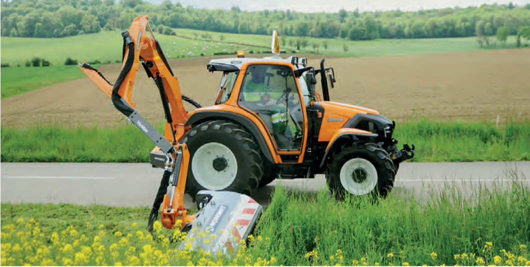
Das Zugfahrzeug „Lintrac with Noremat“ ist konfiguriert für die Pflege von Straßenrandstreifen. Gemeinsam haben Noremat und Lindner eine Reihe von Sonderausstattungen entwickelt. Bild: Lindner
