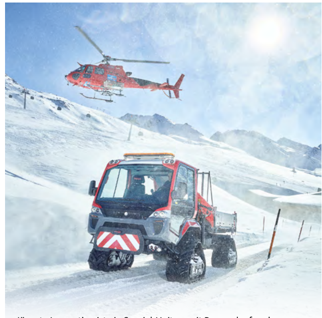
Jüngste Innovation ist ein Spezial-Unitrac mit Raupenlaufwerk.
