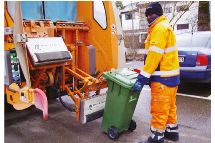
Müllautoschüttung mit Sonden zur Störstofferkennung (auch zur Nachrüstung). Bild: Maier-Fabris GmbH, Tübingen
