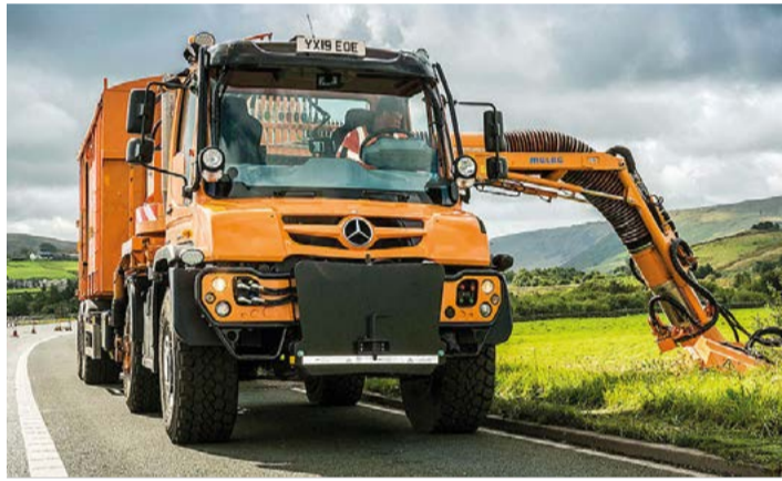
Dank der optionalen Wechsellenkung VarioPilot® können Fahrer von GVA Trees das Lenkrad des Unimog während der Grünflächenpflege auf die linke Seite verschieben. So haben sie direkte Sicht auf ihren Arbeitsbereich. Bild: Mercedes Benz
