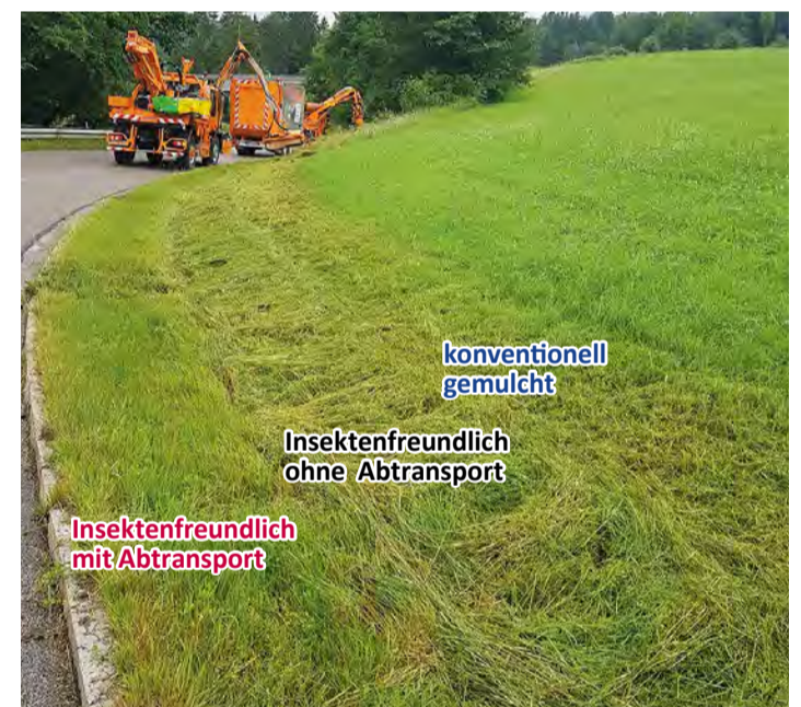
Die unterschiedlichen Schnittbilder: v.l. Mähkopf Eco 1200 plus inkl. Absaugen des Schnittguts, Mähkopf Eco 1200 ohne Absaugen und Schlegelmähtechnologie inkl. Abrollen und Mulchen.
