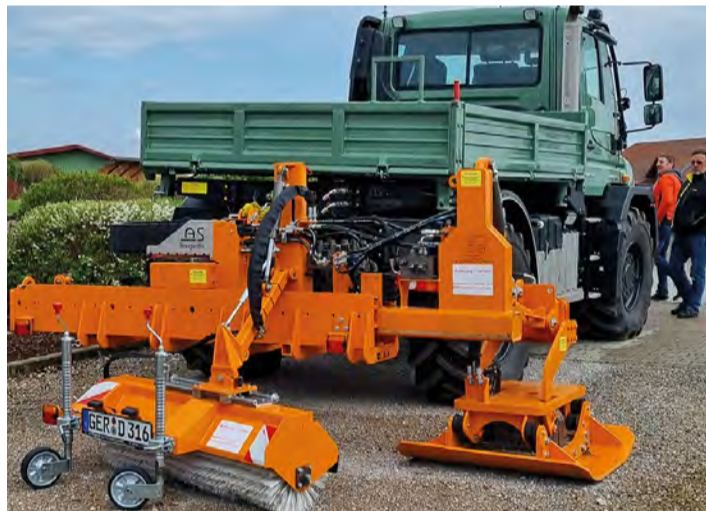
Unimog mit Bankettverdichters Typ PV 5000. Bild: CH
