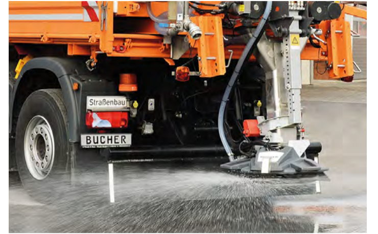
Ein wichtiger Baustein der FS 100 Feuchtsalztechnologie von Bucher Municipal ist die Streueinheit BrineStar® zum breitflächigen Ausbringen reiner Sole. Sie erzielt ein präzises Streubild mit einer Streubreite bis 12 Metern. Bild: Bucher Municipal
