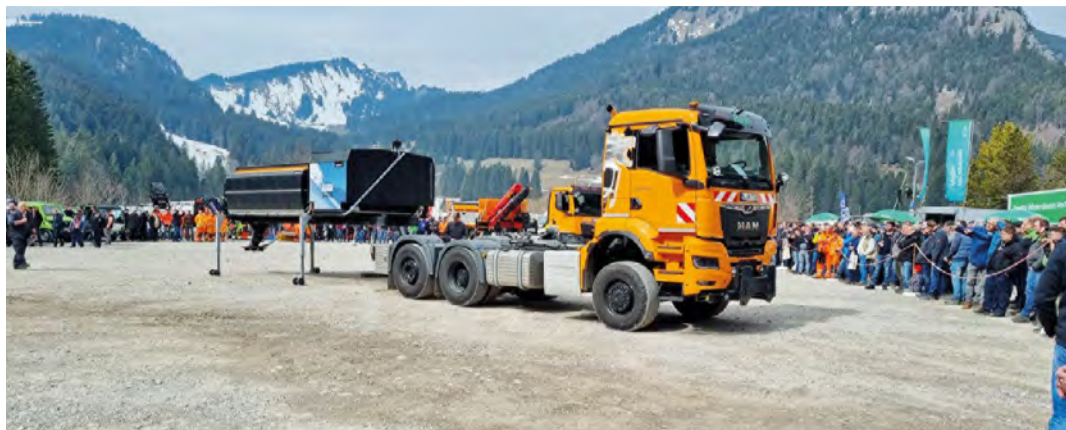
Der Ressenig-MAN TGS 28.510. Die Kugelmann Aufbau-Kombistreumaschine FS 100 lässt sich in fünf Minuten von einer Person abbauen.
