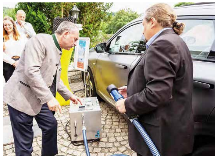
Thomas Steuer (CEO TrigasFI GmbH) erklärt Energieminister Aiwanger (l.) die Prüfeinrichtung zur Eichung von Volumenmessanlagen für Wasserstoff. Bild: StMWI / E. Neureuther
