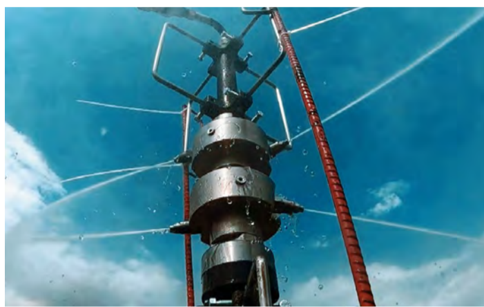
Abb 2: Das Druckwellenimpuls-Verfahren mit Wasserhochdruck arbeitet effektiv und nachhaltig (hier beim Probelauf mit sehr geringem Druck).
