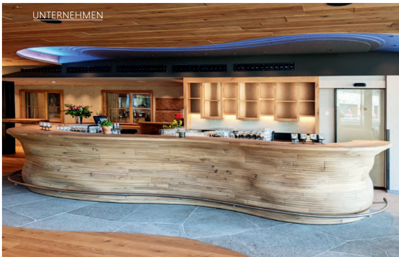
Das organische Design der Theke im Hotel „Allgäuer Berghof“ in Gunzesried ist ein echter Hingucker – sie wurde aus massiver Eiche und in 3D-Form gefräst
