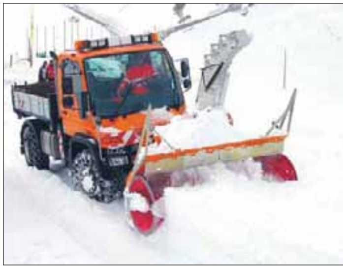
Das Land Kärnten und die Großglockner Hochalpenstraße AG setzen den Unimog U 500 mit Allradlenkung und Vollfräschleuder ein.
