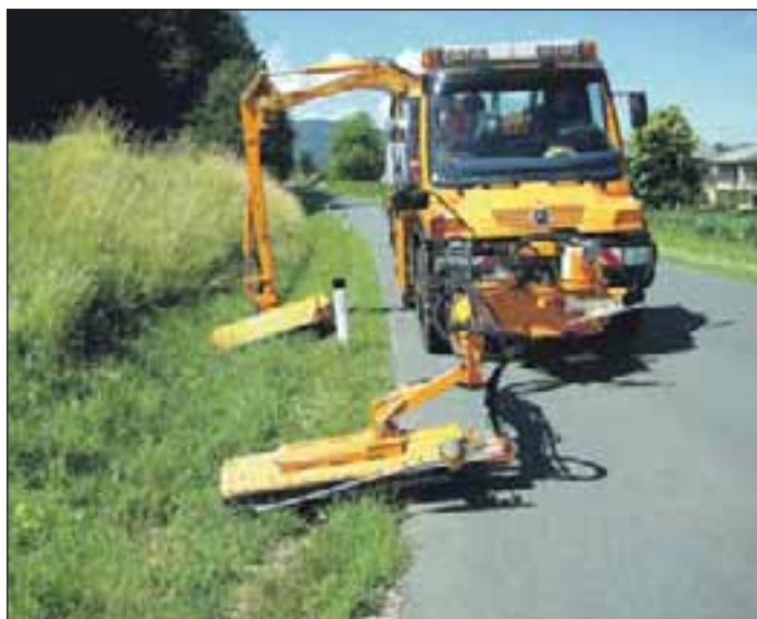
Mähensätze und Schneebeseitigung erfolgen im österreichischen Bundesland Kärnten künftig durch einen Mercedes-Benz Unimog U 500. Den Ganzjahreseinsatz erledigt der Geräteträger dank Hinterachs-Zusatzlenkung, Fahrhydrostat und zwei Hochleistungs-Mähgeräten.
