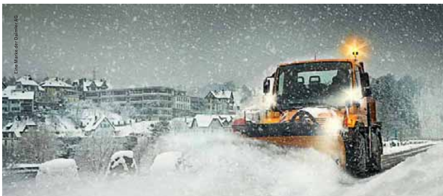
Mähensätze und Schneebeseitigung erfolgen im österreichischen Bundesland Kärnten künftig durch einen Mercedes-Benz Unimog U 500. Den Ganzjahreseinsatz erledigt der Geräteträger dank Hinterachs-Zusatzlenkung, Fahrhydrostat und zwei Hochleistungs-Mähgeräten.
