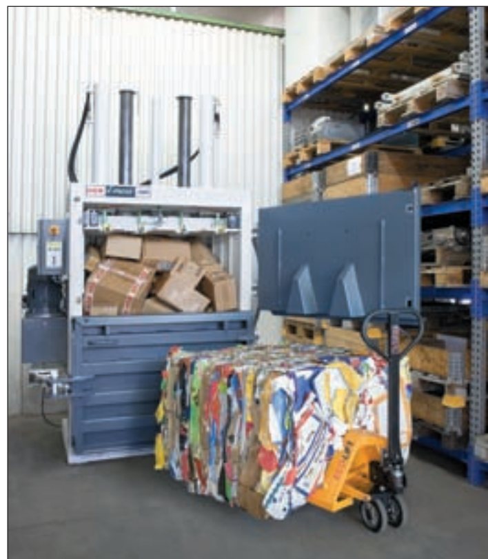
Die vertikale Ballenpresse HSM V-Press 860 L produziert Ballen mit einer Aussparung für den Transport ohne Palette und ist somit eine einzigartige Neuheit im vertikalen Ballenpressenmarkt.
