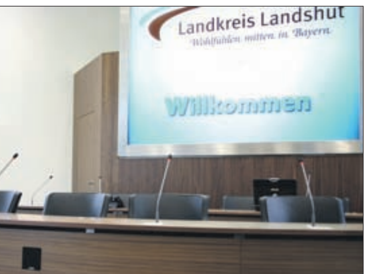
Die Rückprojektionsscheibe mit einer Breite von drei Metern ermöglicht eine kontrastreiche Darstellung der Bilder bei hoher Umgebungshelligkeit.
