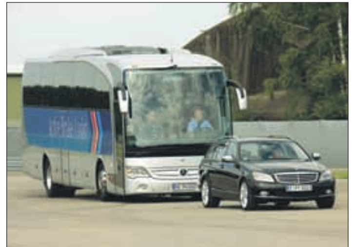
Weltpremiere im Omnibus - Der neue Mercedes-Benz Travego mit Active Brake Assist (Notbrems-Assistent), der automatisch bremsst, wenn ein Auffahrunfall droht und der Fahrer nicht selbst reagiert. Daimler-Foto
