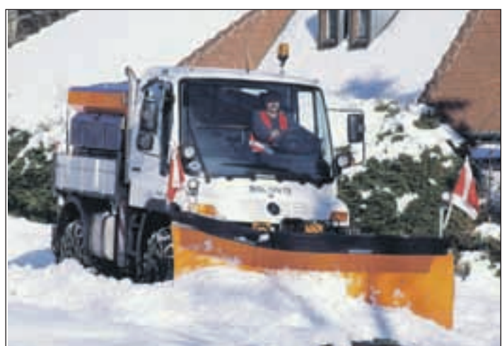
Räumen und Streuen mit dem Unimog in einem Arbeitsgang. In Minutenschnelle lässt sich das universelle Kommunalfahrzeug für jeden Bedarf umrüsten.
