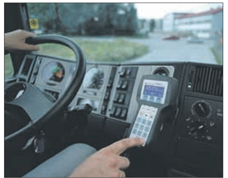
Schon bei zahlreichen Kunden im deutschsprachigen Raum rund um die Uhr im Einsatz: Das Mobidat Telematiksystem. Hier das Bedienteil für's LKW Cockpit. Foto: MOBIWORX
