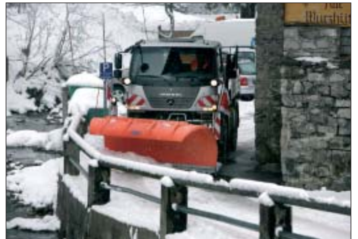
Unimog U20 mit Schmidt Schneepflug CPM 3 und Schmidt Streumaschine Stratos FST 14.
