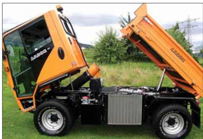
Ladog G129N20 mit Mittelabsaugung: Der kurze, gerade Saugschlauch befindet sich unter der Kabine.
