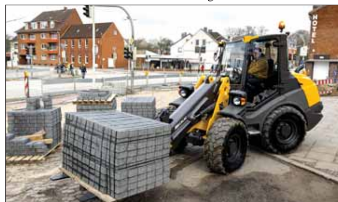
Der neue Knicklader von Mecalac: Der AX 700, hier im Einsatz beim Verladen von Pflastersteinen.
