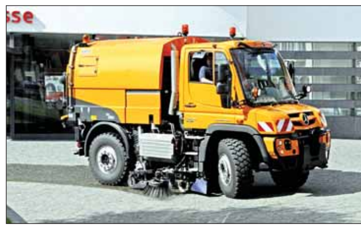
Der Mercedes-Benz Unimog Geräteträger Euro VI (U 216-U 530): Aufbauten für Kommunen, Garten- und Landschaftsbau sowie kommunale Lohnunternehmen.
