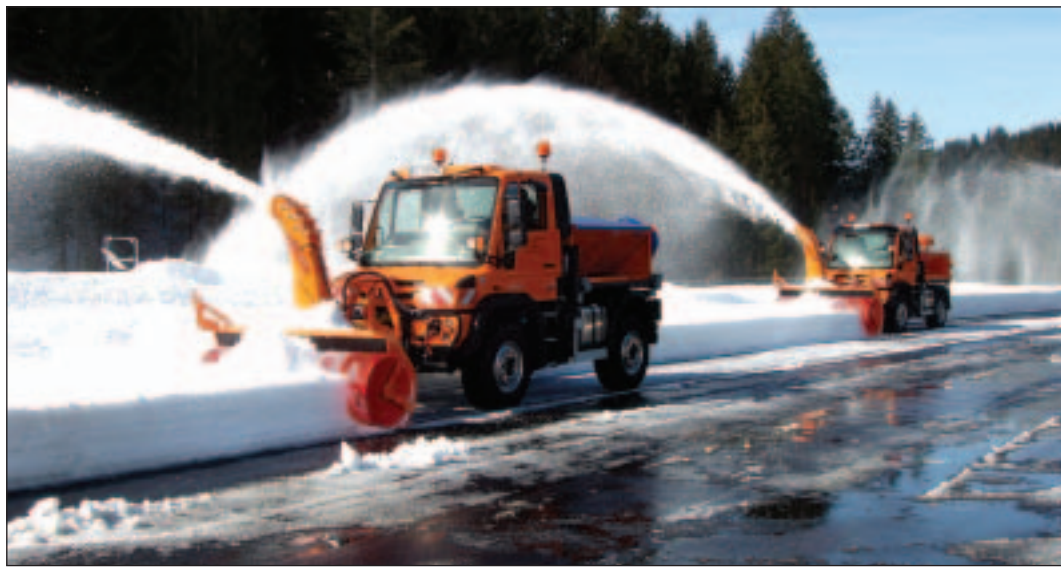
Die Demonstrationsfahrzeuge von Henne-Unimog räumen mit ihren Schneefräsen den Helikopterlandeplatz bei Schloss Elmau von der ca. einen Meter dicken Schneeschicht frei. Bild: cvh
