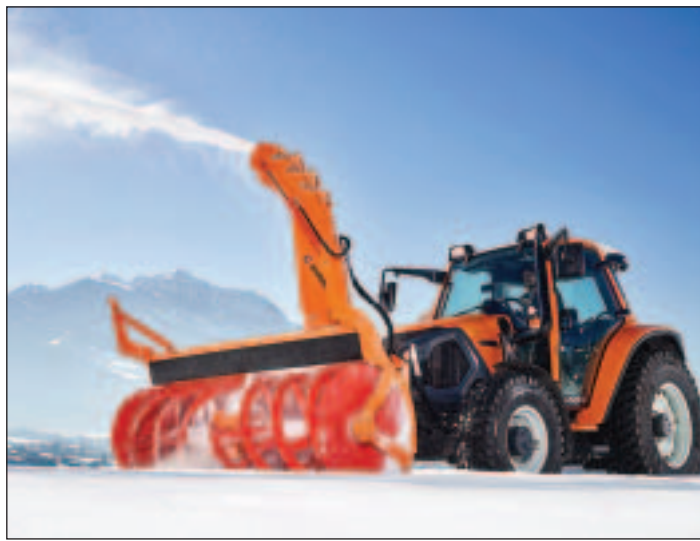
Die Heck-, Front- und Arbeitshydraulik mit Verstellpumpe machen den Lintrac zum vielseitigen Geräteträger.
