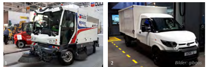
1. Die umweltschonende Straßenkehrmaschine DULEVO 6000 CNG fährt klimaneutral mit Biomethan. 2. Der StreetScooter „Work L“ fährt rein elektrisch und ist mit verschiedenen Aufbauten verfügbar.
