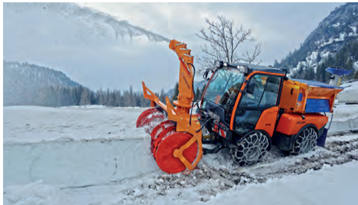
Holder-Modelle sind multifunktional einsetzbar. Unser Bild zeigt ein Grundfahrzeug mit Kahlbacher-Fräse und Fiedler-Streuer. □
