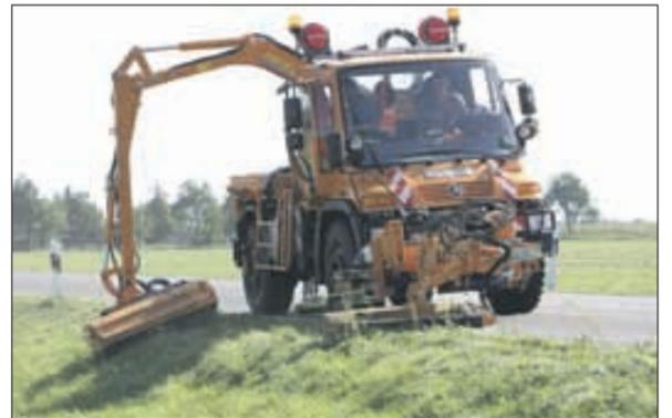
Zu jeder Jahreszeit erledigt der Mercedes-Benz Unimog der Baureihe U 300 - U 500 seinen Dienst in der Kommune. Im Bild ein Unimog mit Mulag-Profi-Mäheinheiten. Ausgestattet mit der innovativen Mähtür und Drehsitz sind mit dieser Gerätekombination außergewöhnliche Mähleistungen im Zweimann-Betrieb möglich. Die Mähkombination besteht aus einem Randstreifenmäher und einem auf der Unimog-Pritsche montierten Böschungsmäher. □
