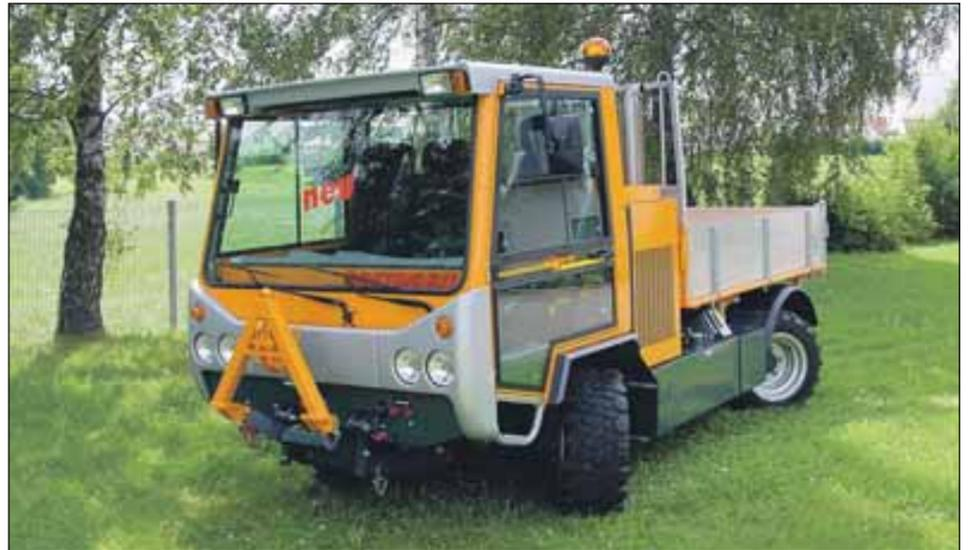
Mit der neuen B-Version der BOKIMOBIL-Familie ist das wendige Einsatzfahrzeug für Transportaufgaben noch besser gerüstet. „B“ steht für breit und meint genau 1,70 Meter. Ansonsten gelten die bekannten Vorteile: Allrad-Lenkung und vier Lenkungsarten (Vorderrad-, Hinterrad-, Rundgang- und Hundegangelenkung) z. B. beim Kehr- und Mäheinsatz. Werkfoto: Kiefer
