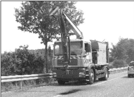
Der Patcher wurde entwickelt für eine wirtschaftliche und wirkungsvolle Ausbesserung von Schlaglöchern, Rissen und vergleichbaren Fahrbahnschäden.
