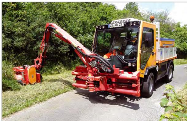
Der neue Ladog mit Auslegemähergerät im Einsatz auf einem schmalen Wiesenweg. **DK**
