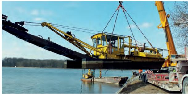
Mit einem 130-Tonnen-Autokran wurde der rund 23 Tonnen schwere Saugbagger aus dem Stauraum des Bahnstrom-Kraftwerks Ingolstadt auf einen Tieflader gehoben und abtransportiert. Im vergangenen halben Jahr wurde mit Hilfe des Saugbaggers rund 19.500 Kubikmeter Sediment in die Strömungsrinne der Donau verlagert.
