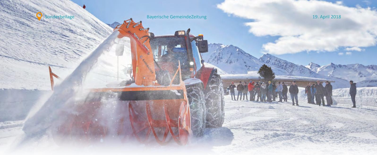
Innovativ: Beim Lintrac kann die Schneefräse über den Joystick auf der Armlehne mit einer Hand geschwenkt und geneigt werden.
