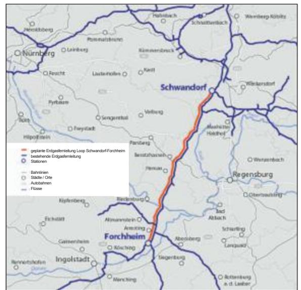
Daten und Fakten: Länge 62 km, Investitionssumme: 119 Mio. €, Inbetriebnahme: 2017, Durchmesser: 1 m, Betriebsdruck: 100 bar, Teilparallelisierung. ■
