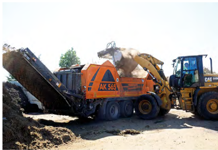
Schreddern ohne Schwierigkeiten: Grünschnitt wird zur weiteren Verwertung in der Kompostierung vorbereitet. Bild: Bauer Dienstleistungen
