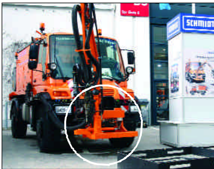
Ein „einfaches“ Vorsatzgerät (im Kreis) ermöglicht verbesserte Reparaturqualität. Mit dem „Road Repair Patcher System“ von Schmidt lassen sich massiv Kosten einsparen.
